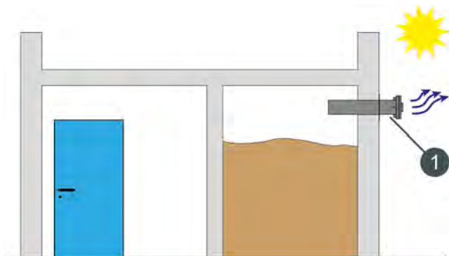
Abb. 11-21: Befüllstutzen im Freien
